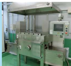
過熱水蒸気発生装置
