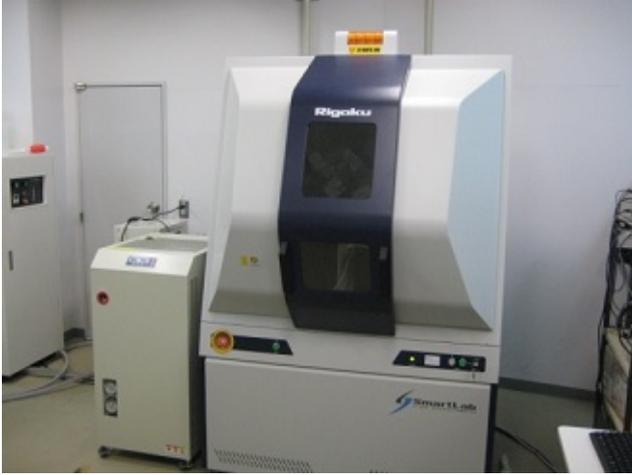
平成26年度「電源立地地域対策交付金事業」により「X線回折装置」を更新しました。本装置は、測定試料に対してX線を照射した際に生じる回折現象を測定・解析す
