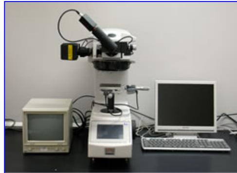
また、試料の調整により焼き入れ深さや脱炭層深さ溶接部の硬さなども測定可能です。
