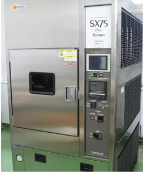
平成20年度財団法人JKAの自転車等機械工業振興補助事業により「キセノンウエザオメータ」を設置しました。本装置は、金属材料、高分子材料、各種工業材料や製品等に太陽光の分光分布に最も近似した光を照射することにより材料や製品の耐候性を評価します。ものづくりにおける重要な指標である使用(性能)耐久性や意匠性維持に関する評価ができますので、ご利用の場合はセンターまでご相談下さい。
